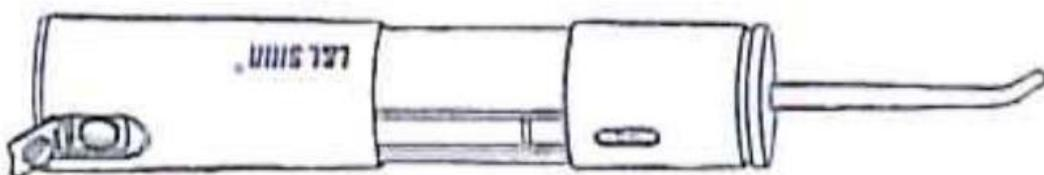
Kao što je prikazano na slici, držite tijelo proizvoda jednom rukom, a rezervoar drugom rukom dok povlačite rezervoar prema dole.
